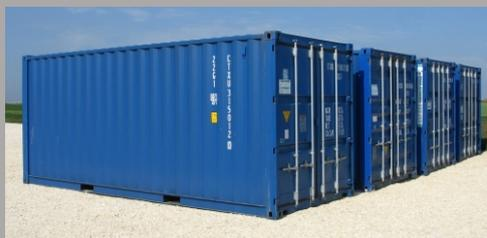
**Grundausrüstung:** Wände aus Stahl-Sickenblech, Stahlprofilrahmen, Holzboden (Schichtholzplatten) auf Stahlquerträgern, Türe doppelflügelig, außen angeschlagen, Drehstangenverschlüsse Stapertaschen, Standardfarbe RAL 5010 enzianblau CSC-Plakette bei 1690
